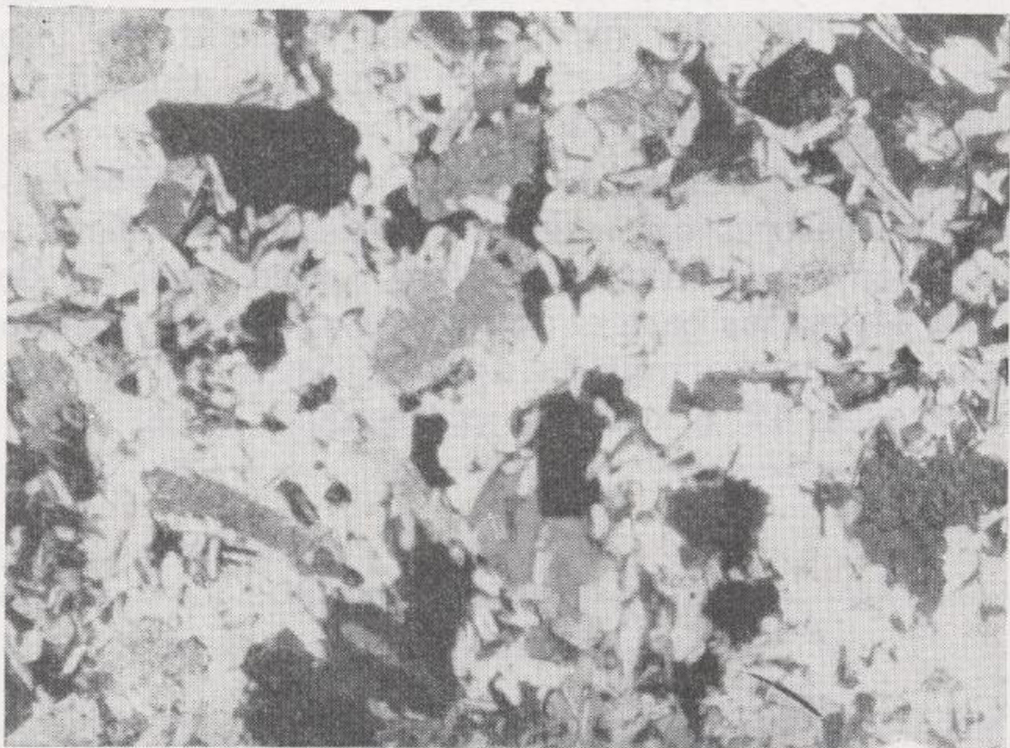
Fig. 6.—(9535. I. L. M.). Canto holocristalino (tonalita). Cristales de cuarzo, plagioclasa, biotita y anfíbol en una textura microgranuda alotriomorfa poiquilítica.
